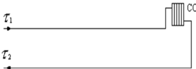
Рисунок 26 Система теплоснабжения закрытая, двухтрубная с непосредственным присоединением системы отопления
