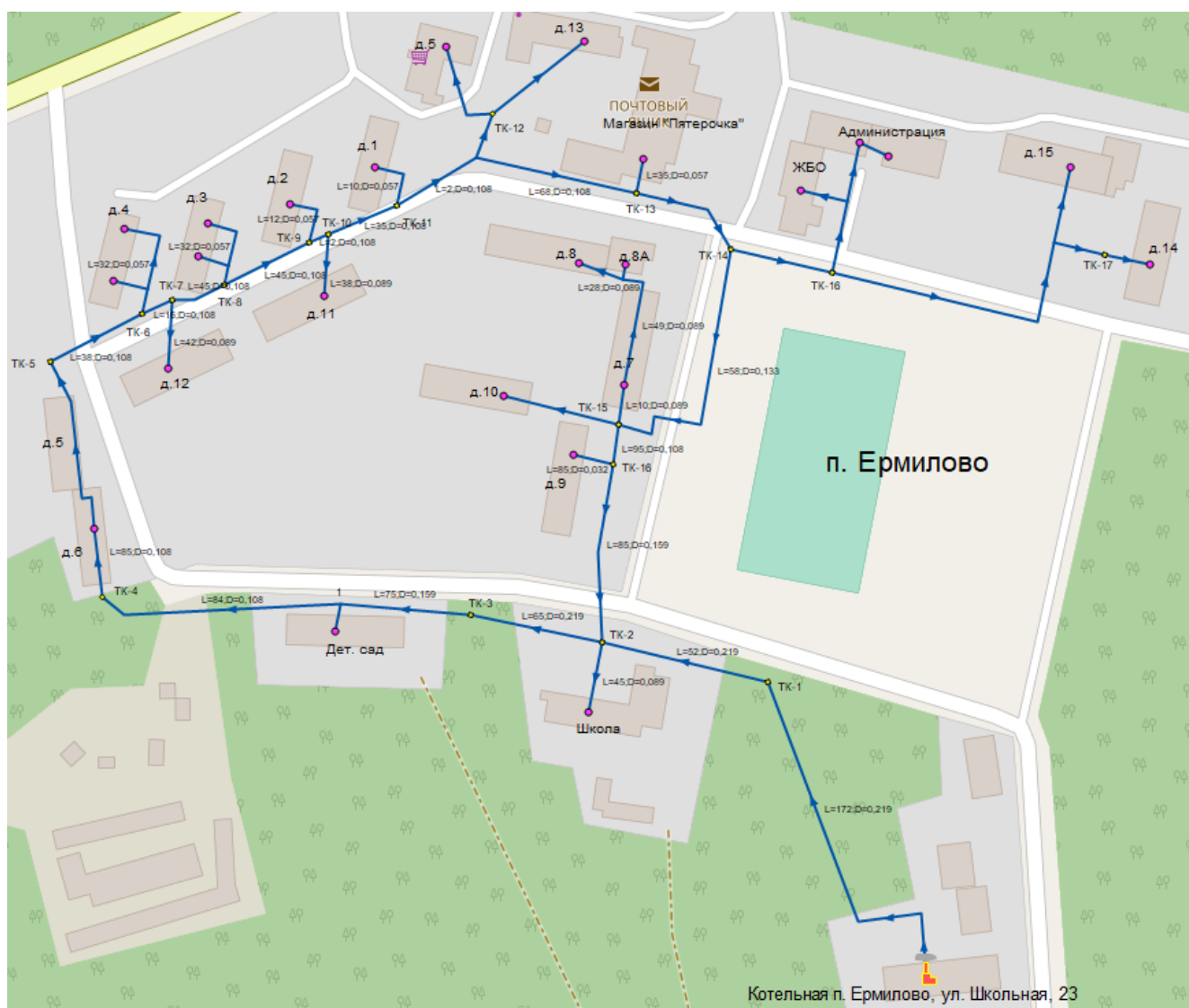
Рисунок 9 Схема тепловых сетей технологической зоны - 3, п. Ермилово, ул. Школьная, 23
