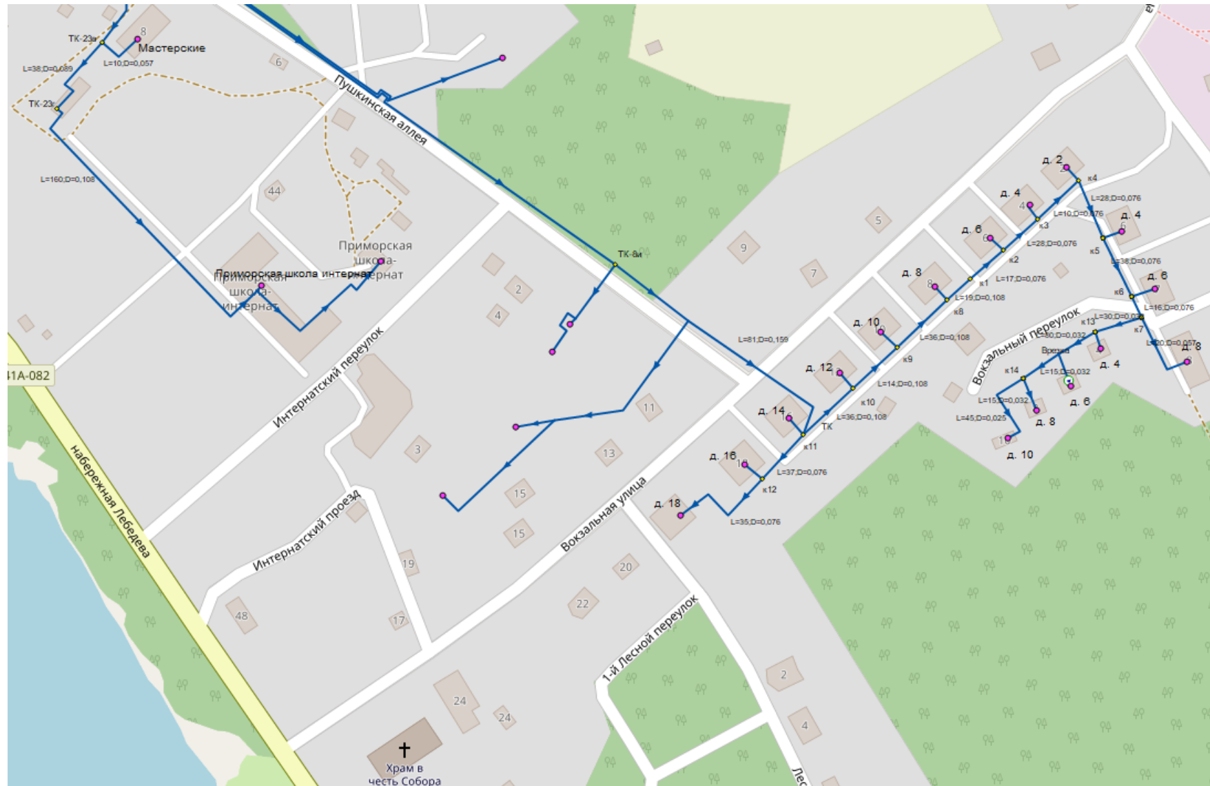
Рисунок 7 Схема тепловых сетей технологической зоны – 1, г.п. Приморск, котельная по ул. Школьная, 24а
